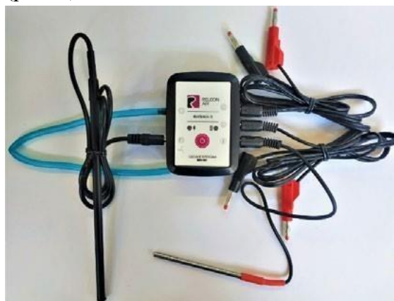
Рис. 9. Беспроводной мультидатчик Releon Air «Физика-5»
